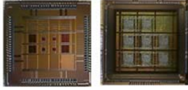
Şekil 2: Sinyal geçişiyle benzersiz ID'ler oluşturan LSI prototipleri (Sol: 65 nm, 2.1 mm 2 ; Sağ: 180 nm, 2.5 mm 2 )
