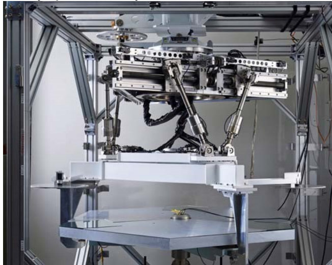
Segment yönetim sisteminin (SHS) prototip robotu
