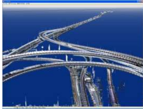
Örnek 2: Renkli kamera görüntüleriyle birleştirilen standart lazer tarayıcıyla 3D kavşak ölçümü
