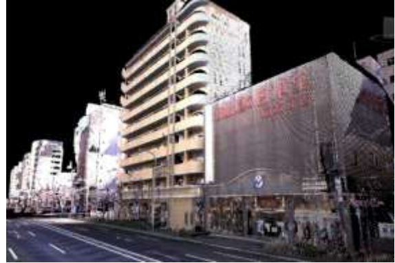
Örnek 4: Opsiyonel uzun menzilli veya yüksek yoğunluklu lazer tarayıcıyla bina görünümünün ayrıntılı ölçümü
