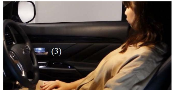
Sensörler yakınlarda yaya olduğunu tespit ettiğinde hareketli ışıklar üç şekilde (1, 2 ve 3) değişir
