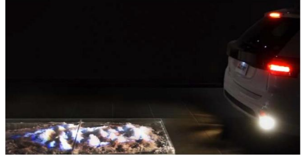
Yol yüzeyine yansıtılan hareketli ışıklar, kötü hava koşullarında bile yüksek görünürlüğe sahiptir
