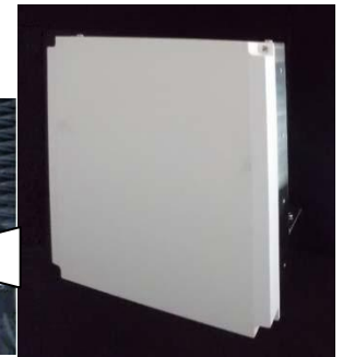
Devasa anten elemanları (512 anten elemanı) bulunan 2 ışınlı anten RF ünitesi
