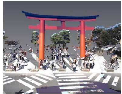
MMS'den alınan verilerle oluşturulan 3D nokta bulutu
