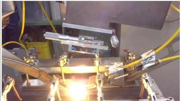
Resim 1. Fiber-lazer kaynak sırasında sıçramanın görsel karşılaştırması
